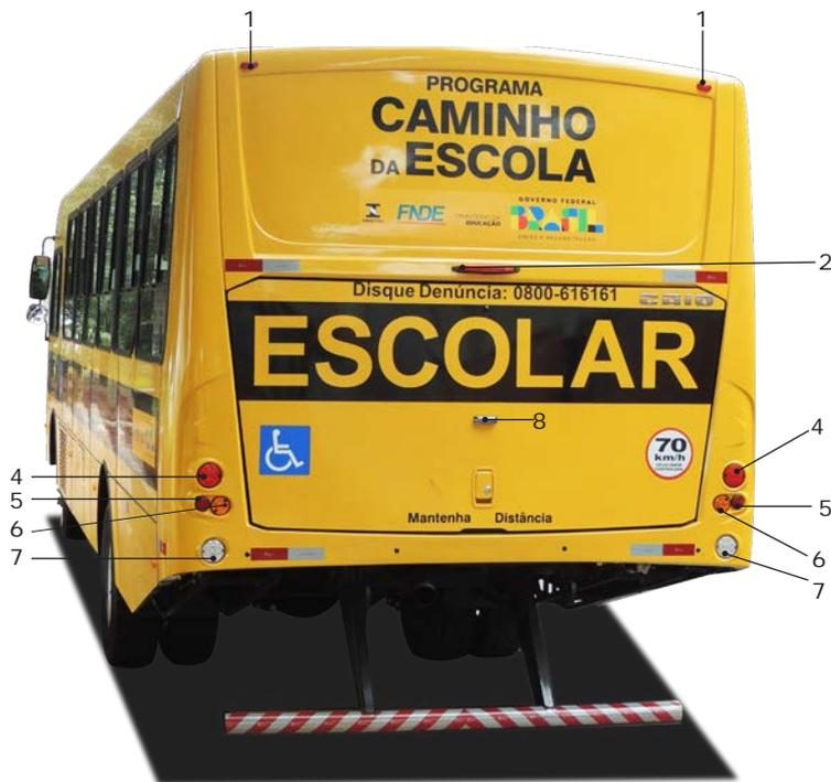
A substituição dos itens **1**, **2** e **8** da imagem ao lado, é feita através do parafusos de cabeça cilíndrica, com medida de  $\varnothing 4,2\text{mm}$  e 25mm de comprimento que fixam as lanternas.
