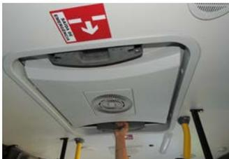
**03** - Para encaixá-lo novamente, com uma mão, segure o mecanismo e com a outra, puxe a tampa para baixo através do encaixe para as mãos. Repita este procedimento para o outro lado do alçapão.
