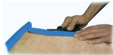
**03** - Coloque o novo revestimento e passe os arames nos orifícios.
