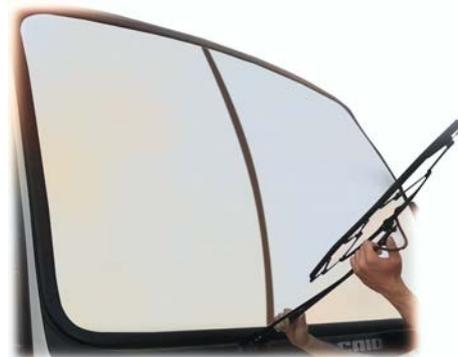
**02** - Solte o parafuso central de fixação da palheta.
