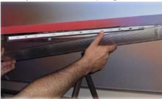
**03** - Solte a conexão de energia e substitua a placa de led.
