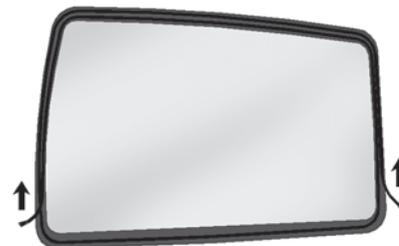
Coloque a alavanca entre a borracha e a fibra nos cantos superiores e inferiores, esquerdo e direito, forçando a borracha para fora em toda a curva do vidro.
