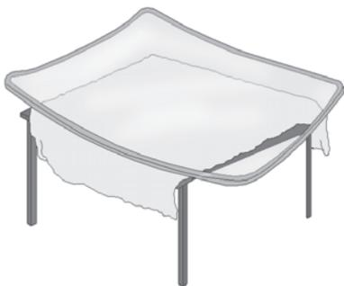
**02** - Coloque o quadro de borracha e a “cordinha” dentro do sulco da borracha.
