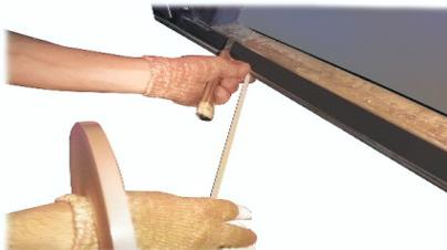
**04** - Passe massa de calafetar na região onde será colada a chapa, para evitar que a mesma fique vibrando com a trepidação do ônibus.
